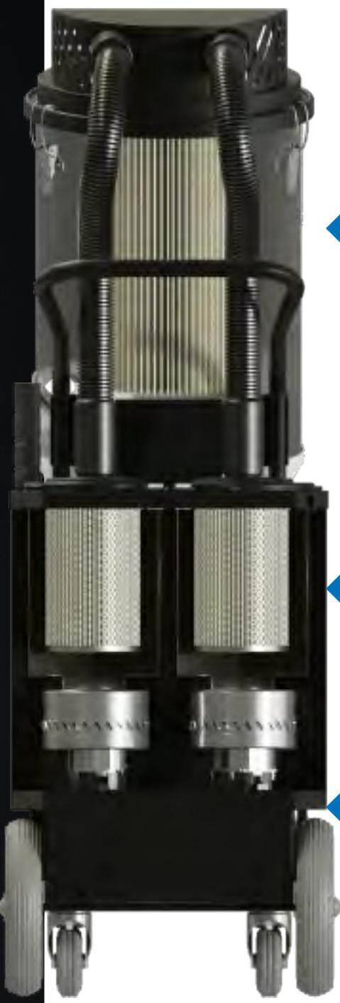
Filtro primario con media filtrante HEPA+PTFE, utile a garantire una superficie liscia e diminuire il potere impaccante delle polveri.
