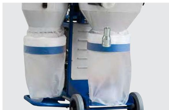
Sistema di raccolta a sacco continuo e ruote con freni.
