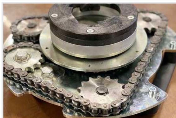
Planetario con ingranaggi in acciaio temperato per la massima affidabilità e performance.
